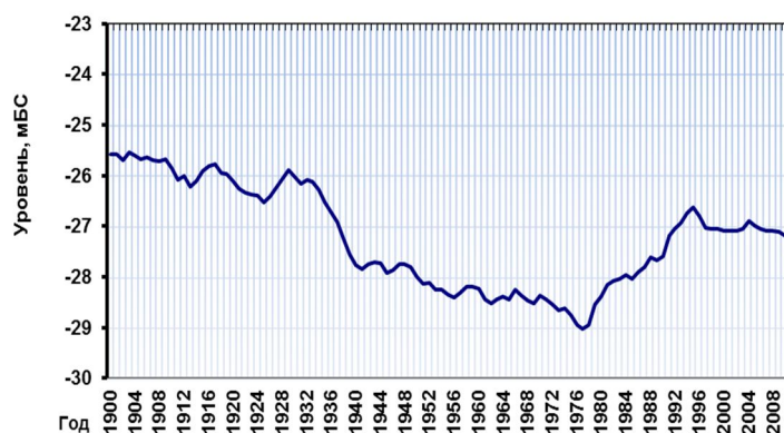
Рис. 1. Средние годовые уровни Каспийского моря по уровенному посту Махачкала, в см над «0» графика, равного минус 28,00 м.абс. (Б.С.)
